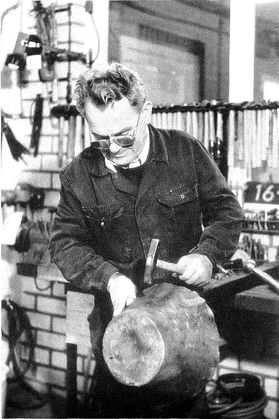
Afb. 4. Jan de Kievit drijft een koperen bak op een lange tas in zijn werkplaats. Heeze, circa 1985.
